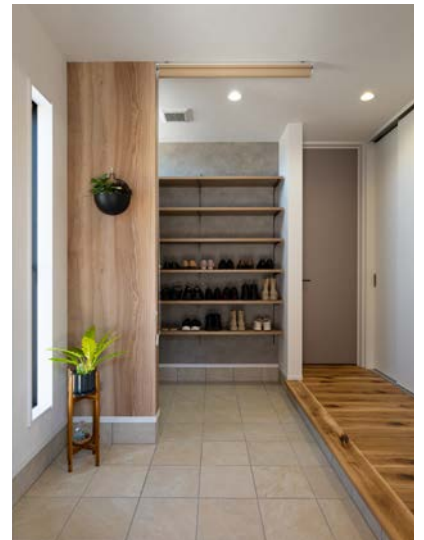
広々とした玄関には、シューズクローゼットを備えた収納スペースを設置。あえて仕切り柱を採用せずオープン仕様にし、圧迫感と動線阻害を解消しています。写真右側には広々とした収納室を設け、大型の3枚扉で仕切っています
